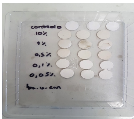
Figura 2.2: Comprimidos de Ben-U-ron preparados por compressão com a adição de 4-AF em diferentes quantidades.
