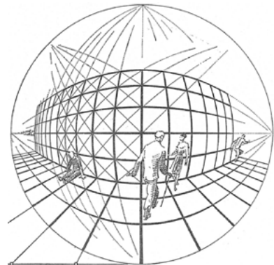
Figura 3 - Grelhas uniformes em perspectiva esférica. Note-se a convergência de paralelas frontais no círculo exterior do disco de projecção. Extraída de Barre e Flocon, 1964, p.178.
