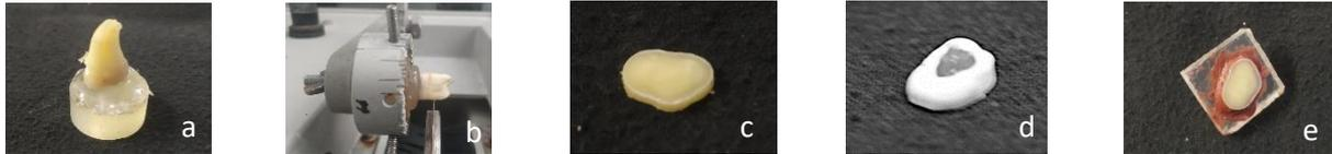
Figura 1 – a) Dente colado ao suporte acrílico com cera colante; b) Secção do espécime; c) Disco de dentina; d) Aplicação de ácido fosfórico na porção pulpar; e) Selamento com godiva nas peças acrílicas
