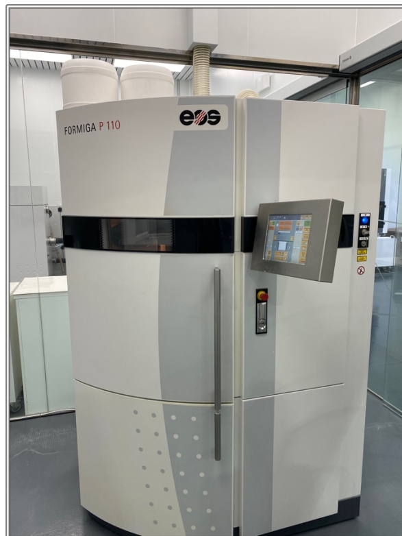
Figura 12. Impresora 3D Formiga P110 (EOS) como la utilizada para los estudios que presentamos. Cortesía de Avinent Implant System, S.L. (Barcelona, España)
