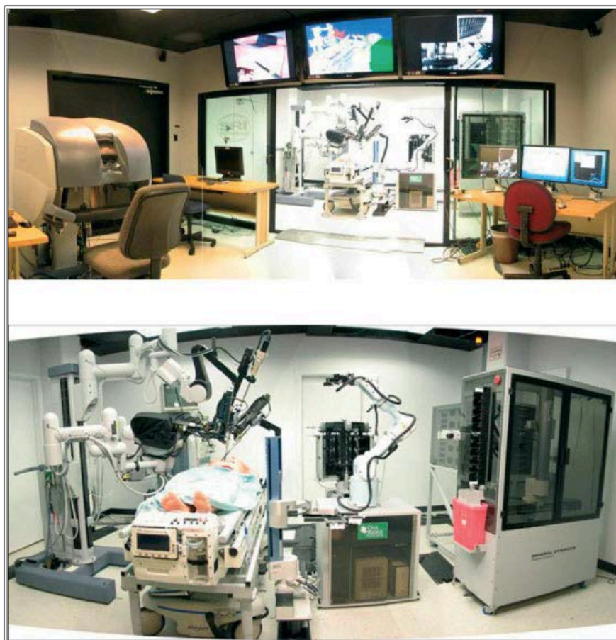
Figura 10. Trauma Pod; el sistema robot telemático semiautomático. En la imagen de arriba la celda control y en la imagen de abajo la celda quirúrgica. Reproducido de: García P et al. Int J Med Robot. 2009 63
