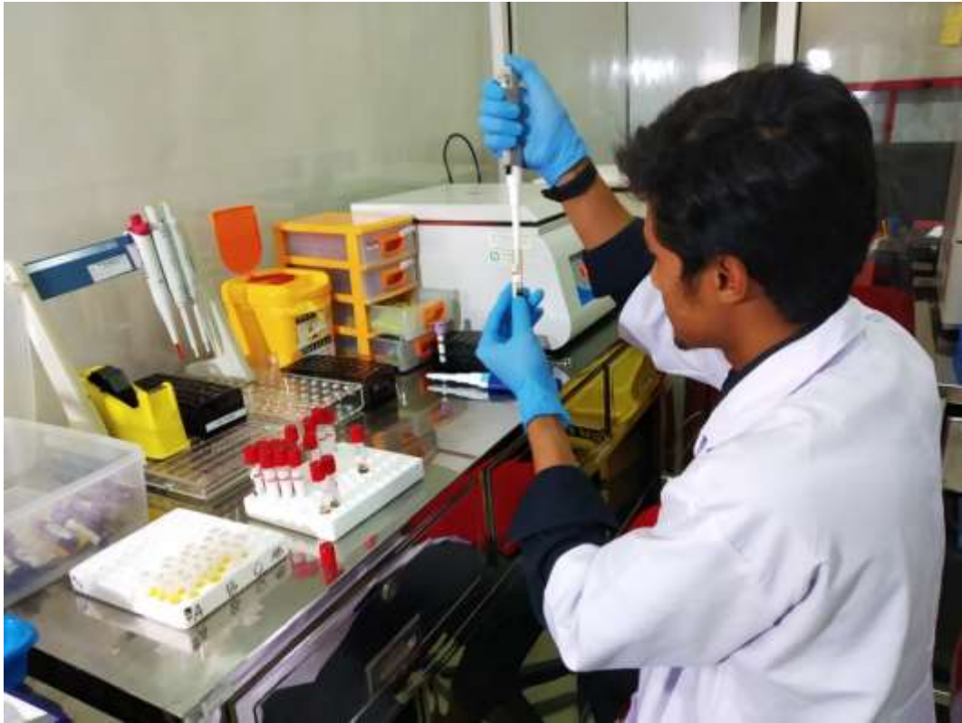
Gambar 9. Proses pemisahan serum yang sudah di centrifuge menggunakan multichannel pipet dan blue tipe kemudia dipindahkan ke dalam eppendorf tube 1.5ml
