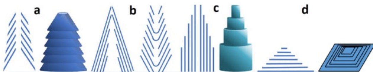
Figure 2 : Schéma de morphologies graphéniques dont les formes coniques sont déterminées de trois façons différentes par la texture, c'est-à-dire l'orientation des couches de graphène par rapport à l'axe du cône. (a) et (b) trois textures différentes pour les feuilles de graphène obliques par rapport à l'axe du cône ; (c) feuilles de graphène parallèles à l'axe du cône ; (d) feuilles de graphène perpendiculaires à l'axe du cône. Les dessins au trait à côté des modèles 3D schématisent la façon dont la texture interne des morphologies coniques globales est vue sous forme d'images projetées telles qu'obtenues par MET à haute résolution. Bien que les modèles 3D en (a), (c), (d) présentent une configuration en assemblages de graphènes multiples, les textures projetées seraient les mêmes dans le cas d'une configuration à base d'un enroulement hélicoïdal d'un graphène unique.
