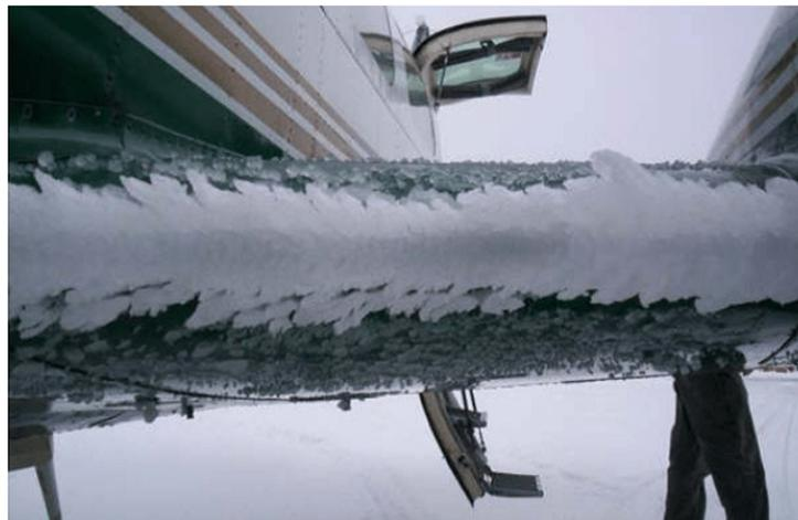
FIGURE 1. – Accumulation de givre sur le bord d'attaque d'une aile (ONERA).
