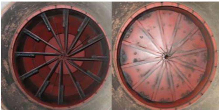
FIGURE 3.3. – Système de pales permettant d'ajuster la vitesse d'écoulement dans la veine d'essai, en ouverture (gauche) et fermeture (droite) maximales ([Morilhat, 2018](#))
