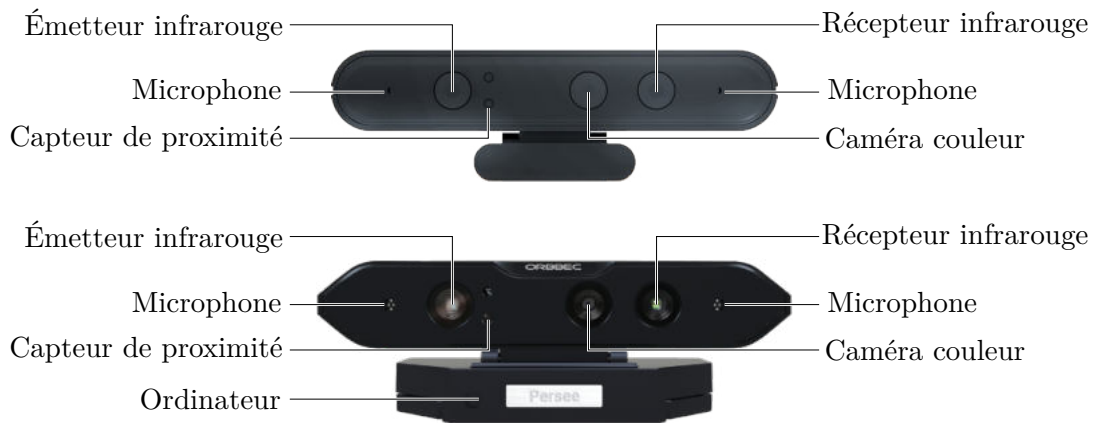
FIGURE 1.20 – L'Orbbec Astra (en haut) et l'Orbbec Persee (en bas) et les différents éléments qui les composent.
