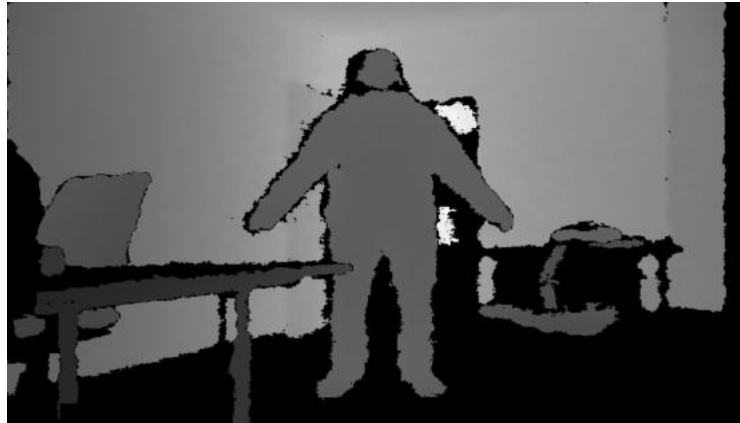
FIGURE 1.21 – Exemple d’image de profondeur acquise avec le capteur de profondeur de l’Orbbec Astra.
