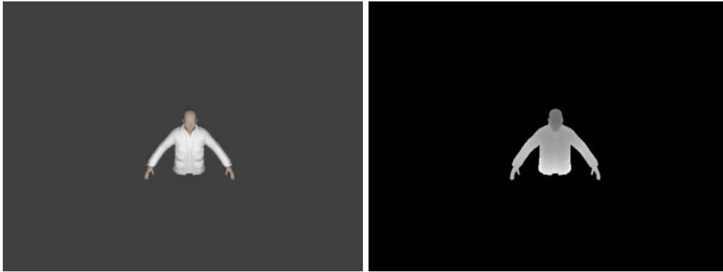
FIGURE 5.4 – Exemple de modèle avec rendu couleur (à gauche) et son canal Z (à droite). Le canal Z d’un modèle correspond à la distance de chaque pixel à la caméra, c’est donc sa profondeur. Pour le rendu du canal Z, plus la distance est importante, plus le pixel est clair, et un pixel noir signifie une absence d’information.
