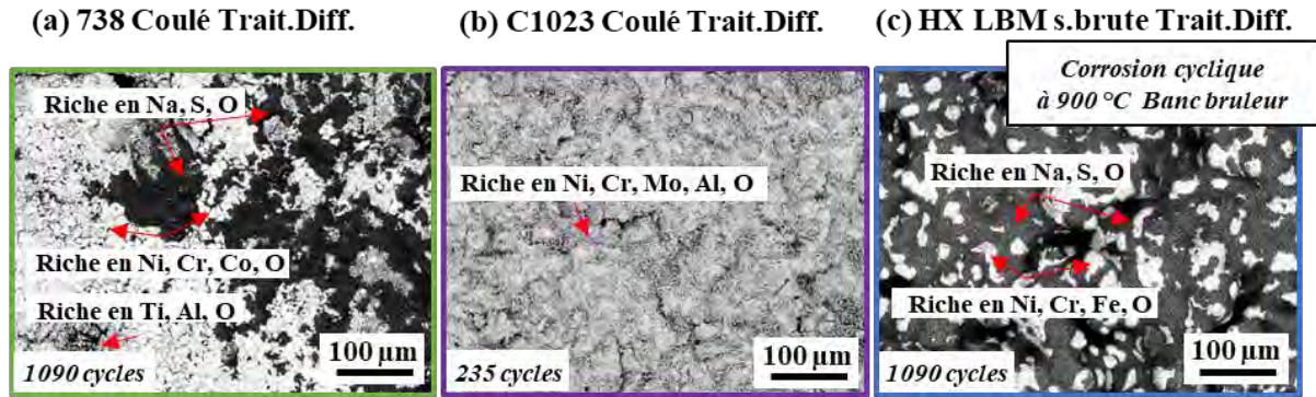
Figure 111. Micrographies MEB (rétrodiffusées) des couches d'oxydes en vue extérieure des échantillons (a) 738, (c) C1023 et (e) HX. Analyses effectuées après avoir subi des cycles à 900 °C sur le banc brûleur, cycles de 1 h à haute température et 15 min de refroidissement naturel.
