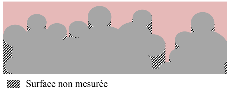
Figure 55. Schéma montrant la surface d'un échantillon EBM qui n'est pas mesurée lors de l'analyse au microscope à variation de focus.
