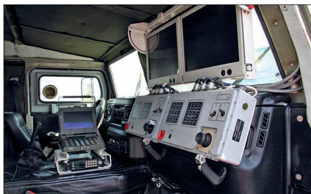
4. ábra. Az irányzó kezelőpaneljei a jármű műszerfalára rögzítve
