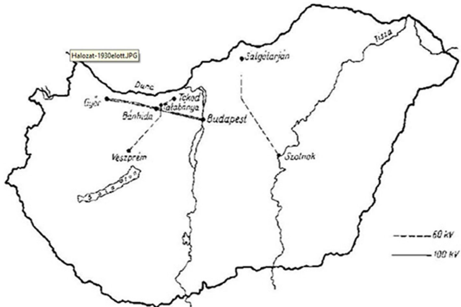
16. ábra Magyarországi villamos hálózat az 1930-as években (Tihanyi 2016) Figure 16. Electricity network in Hungary in the 1930s (Tihanyi 2016)
