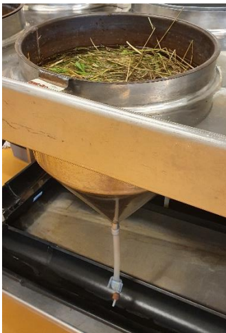
Figur 5 Baerman tratt fylld med gräsprov.
