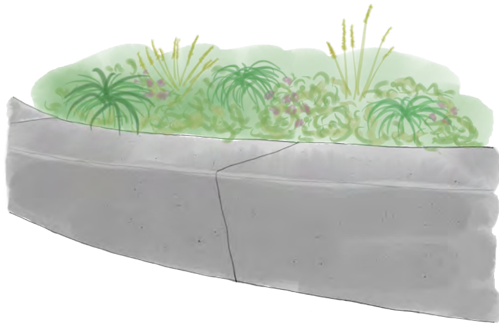
Förslag till murkant. Djup 40 centimeter och höjd 50 centimeter, vilket är vanliga höjder och djup på stolar och bänkar, samt ger plats till perenner. Där träd och buskar placeras bör djupet vara större utifrån lämpliga riktlinjer. Av: Cecilia Karlsson
