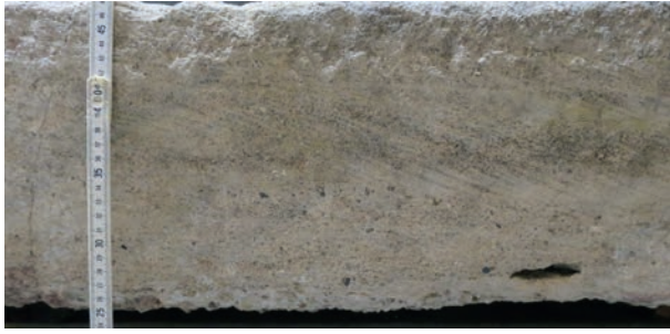
Abb. 2: Augusta Raurica. Grobkörniger Buntsandstein mit typischer Schrägschichtung. Randbereich eines Architekturelements ohne Inschrift aus Augusta Raurica (Grosssteinlager-Nr. 2811).
