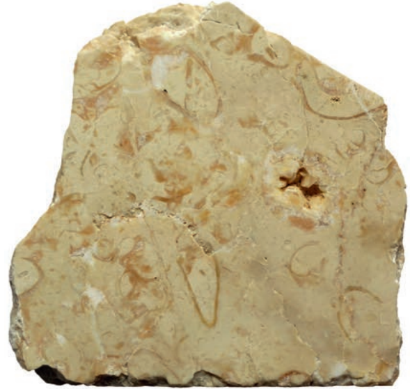
Abb. 19: Augusta Raurica. Fossilreicher, dichter Jurakalk mit hellbraunen Muscheln (Rudisten-Kalk) und Kluftfüllungen aus Kalzit. Modern polierte Rückseite einer 2,2 cm dicken Platte ohne Inschrift der Wandverkleidung aus der Curia von Augusta Raurica in der Vergleichssammlung des IPNA. Länge der unteren Kante 13 cm.
