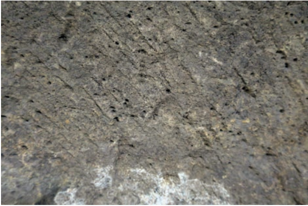
Abb. 4: Augusta Raurica. Feinkörniger Plattensandstein mit homogener poröser Oberfläche und parallel verlaufenden Bearbeitungsspuren, verwendet für den Grabstein 100 des Bellinius Rhenicus. Höhe des Bildausschnitts 10 cm.
