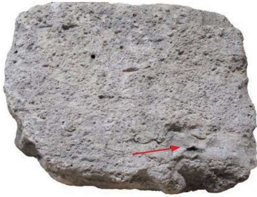
Abb. 11: Augusta Raurica. Kreidiger Korallenkalk (St.-Ursanne-Formation) mit unregelmässiger poröser Struktur und Fragment einer grossen Koralle (Pfeil), mit der Inschrift 96. Höhe des Steins 25 cm.
