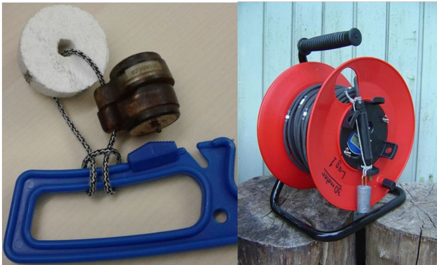
Figur 1: Två temperaturloggar fästa vid nätsticka (till vänster, foto: Ola Renman) och termistor med lod och lina (till höger foto: Björn Ardestam).
