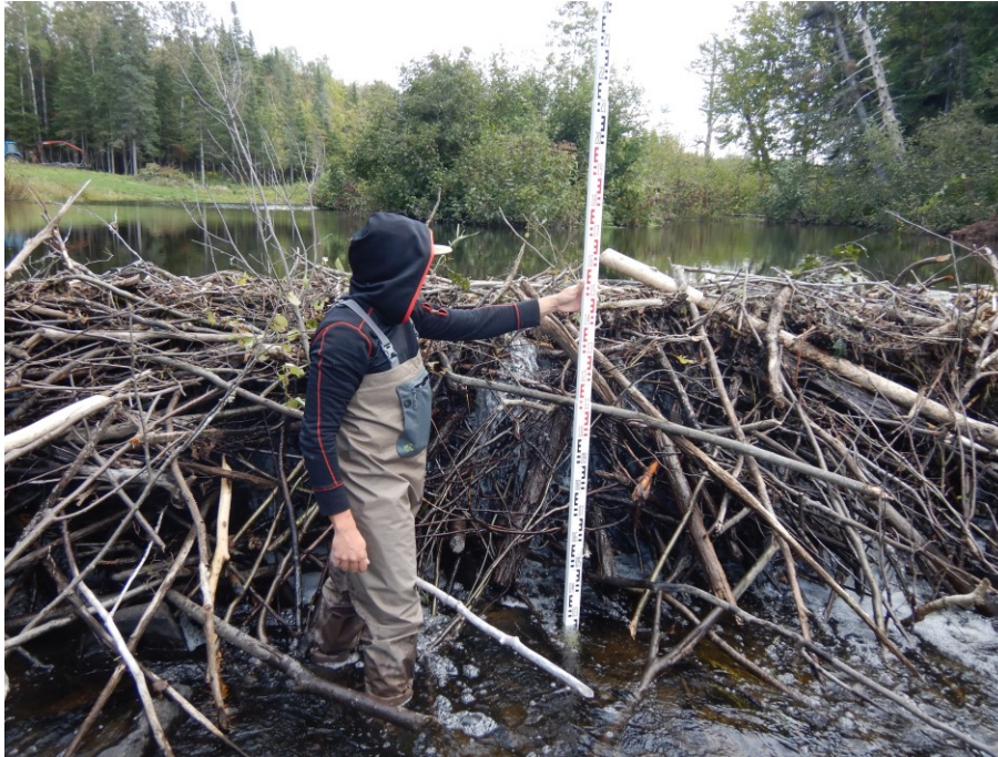
Photo 1. Mesure de la hauteur moyenne et hauteur de chute à l'aide d'une règle d'arpenteur au site du barrage 3. Vue vers l'amont.
