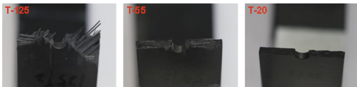
Abbildung 2.9: Bruchbilder von Proben mit Lagendicken von 125, 55 und 20 \text{g}/\text{m}^2 nach [38] Bei den bisher vorgestellten Zug-, OHT- und OHC-Festigkeiten beginnt der Schaden sich demzufolge erst bei bereits sehr hohen Belastungen zu entwickeln.
