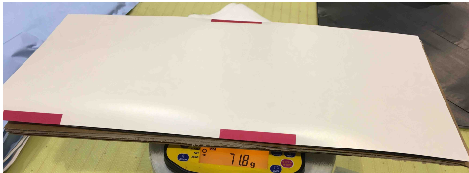
Abbildung 3.6: Messung des Flächengewichts, hier des Prepregs mit Backing-Papier
