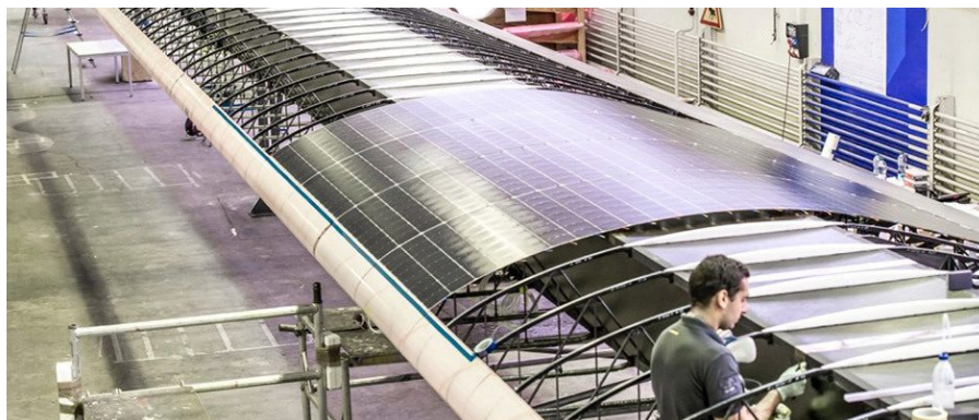
Abbildung 2.11: Flügelstruktur der Solar Impulse 2 [59]
