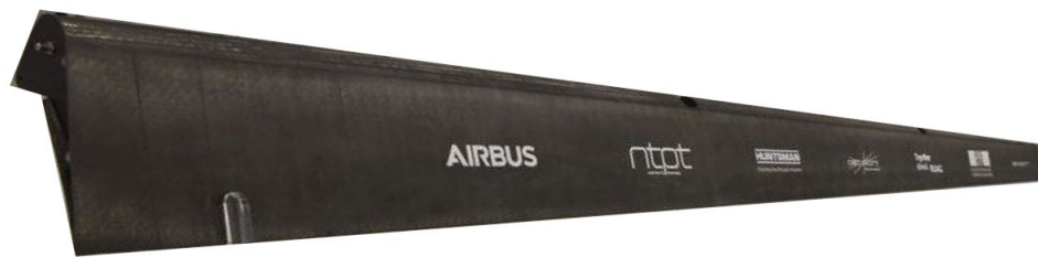
Abbildung 2.12: Querruder-Prototyp von Airbus und NTPT [60]
