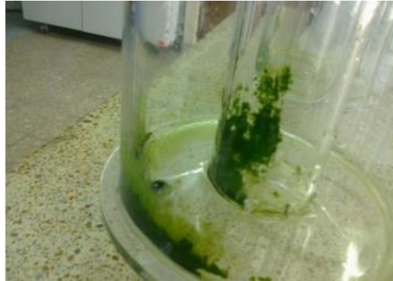
Figura 4.5: Adherencia y sedimentación de microalgas en biorreactor airlift
