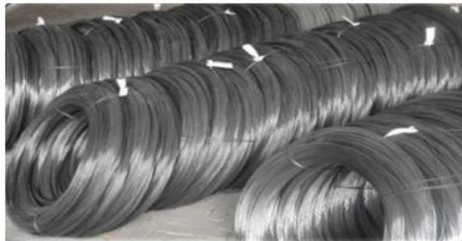
Ilustración 3. Cable de acero de alta tensión que formará el talón del neumático
