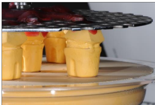
Abbildung 11: Gipsduplikate auf dem Positionierungssockel mit modifizierter Übertragungsspinne
