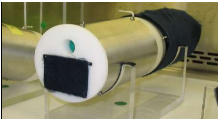
Figura 7. Prueba de irritación por contacto (obsérvese la cubierta de paño oscuro que cubre los puertos de visión en la tapilla y el cilindro claro).
