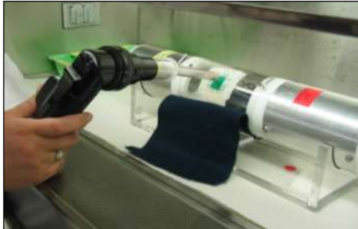
Figura 10. Transferencia de mosquitos al cilindro claro del sistema de repelencia espacial.
