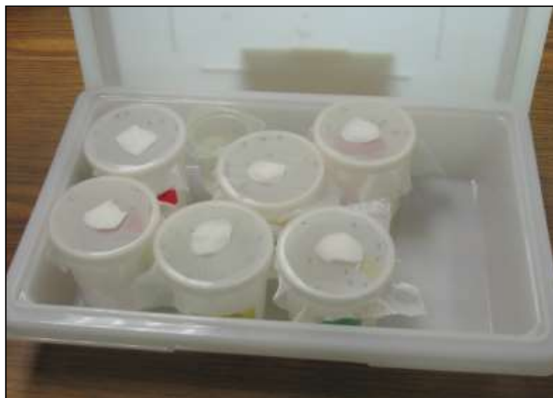
Figura 12. Vasos de recuperación con los insectos sometidos a la prueba de toxicidad (las torundas de algodón contienen azúcar al 10%).
