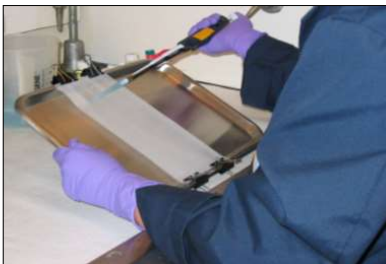
Figura 5. Preparación de las redes de tratamiento aplicando las formulaciones de insecticidas en las dosis a evaluar (tamaño de la red: 275 cm 2 ).
