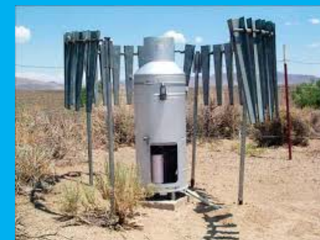
Ott Pluvio gauge 3
