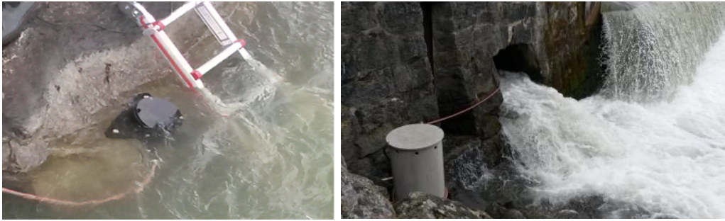
Lage des Einstromkopfes und des Schwebstoffsammlers an der Öztaler Ache © TU Wien/Ottavia Zoboli.
