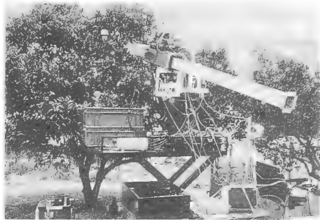
写真10-28 果樹園用収穫ロボット (1986年開発。果実の周辺認識装置や果実を優しく把持するハンドを有する。)
