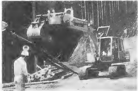
写真10-20 林業工学研究室：演習林におけるの伐出作業調査。本講座考案のウインチのアタッチメントを取り付けたエクスカベータによる試験作業である。写真は土場で材の整理作業を行っているところ。
