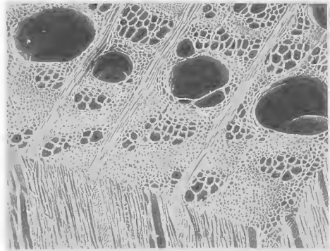
写真10-38 ケヤキ材の走査電顕像
