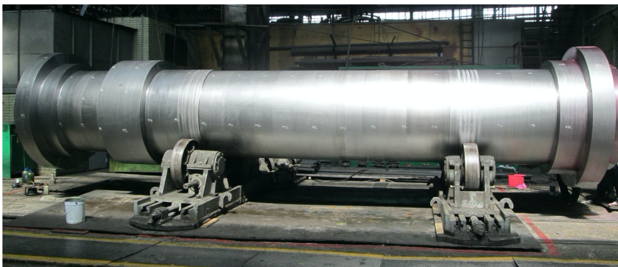
Slika 2.1: Vratilo turbine u predobradi, Fabrika LMZ, Sankt Petersburg, Rusija
