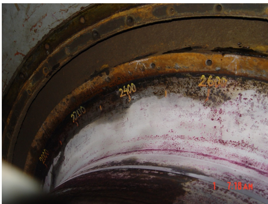
Slika 3.8: PT ispitivanje na obimu od 2200 – 2600 mm [15]
