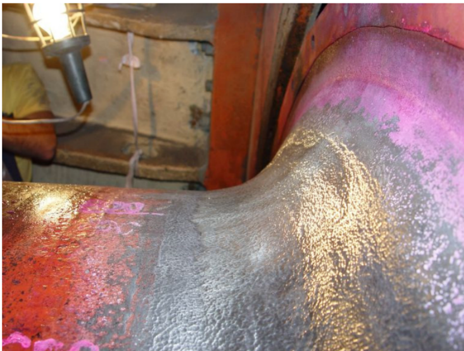
Slika 2.8: Izgled prelaznog radijusa nakon obrade pneumatskim čekićem sa zaobljenim vrhom [12]
