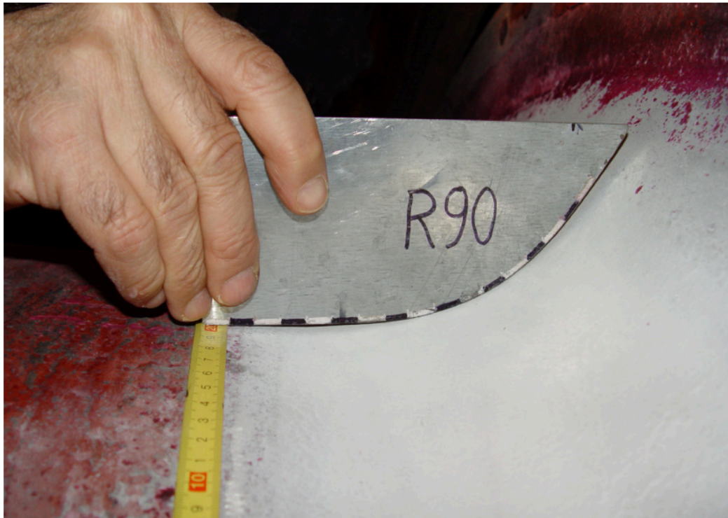
Slika 2.7: Kontrola prelaznog radijusa šablonom R90 [12]
