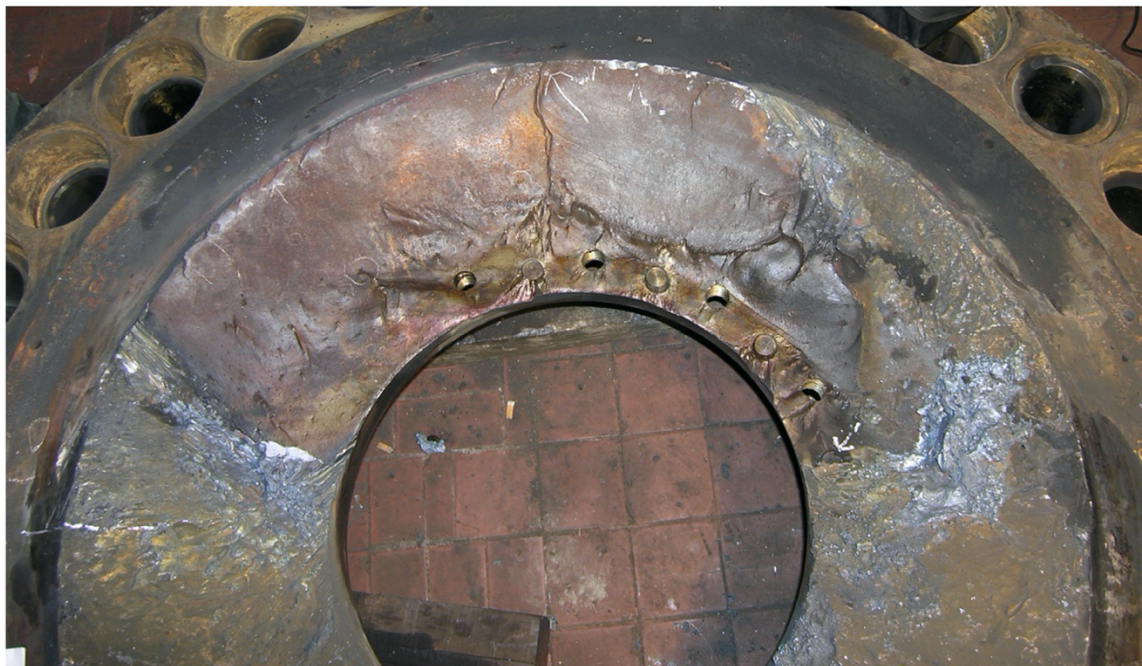
Slika 3.10: Izgled prelomne površine vratila turbine A6 [15]
