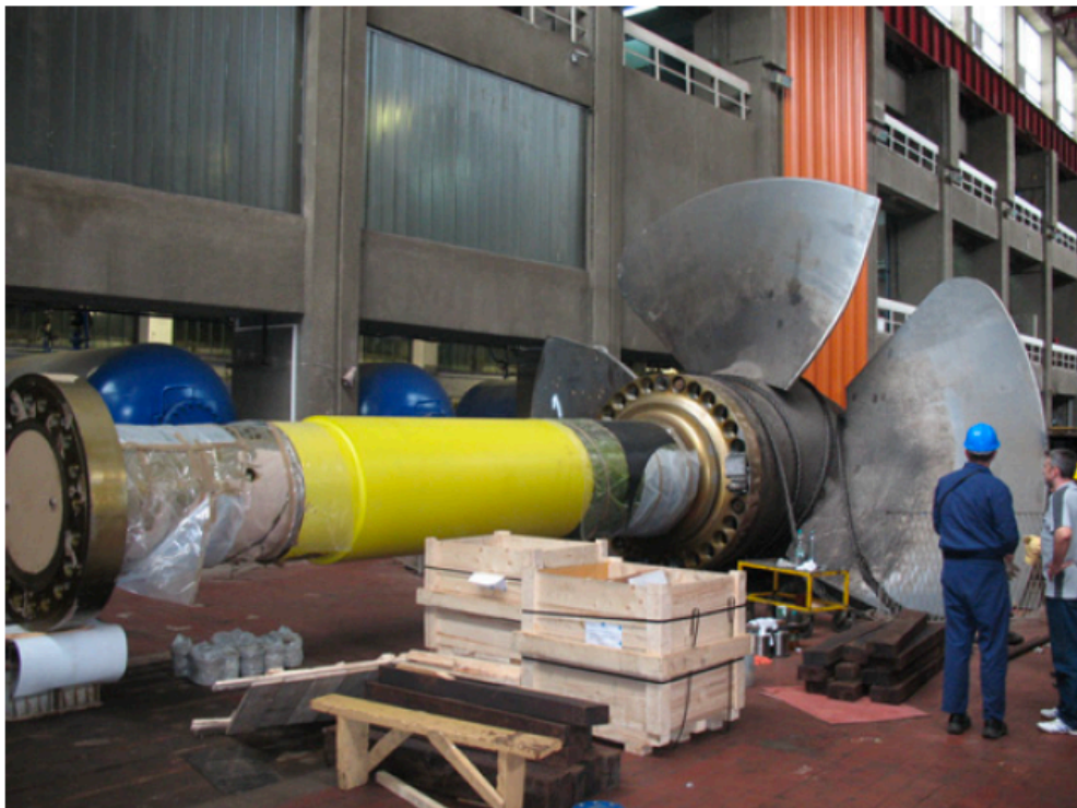
Slika 2.2: Demontirano vratilo turbine sa glavčinom i lopaticama [1]
