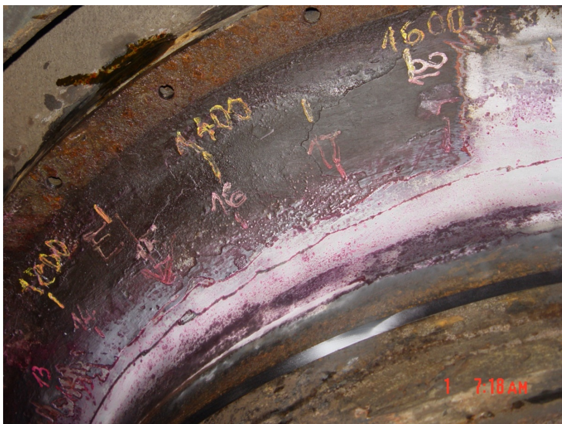
Slika 3.7: PT Ispitivanje obima vratila u dužini od 1200 – 1600 mm [15]
