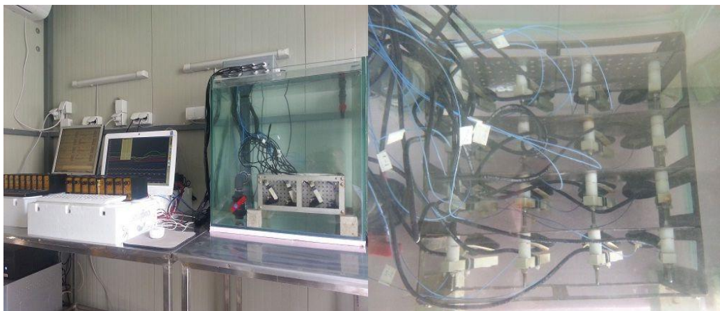
Slika 5.2. Automatizovani sistem za kontinuirani monitoring fizioloških biomarkera dagnji
