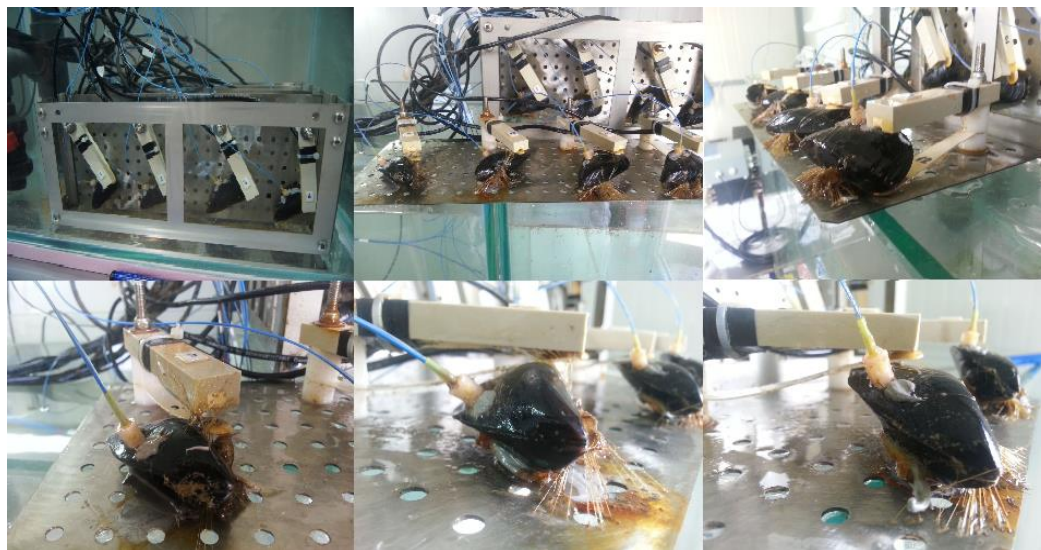
Slika 6.34. Pričvršćivanje dagnji pomoću bisusnih niti za ploče potapajućeg modula i magnetne senzore
