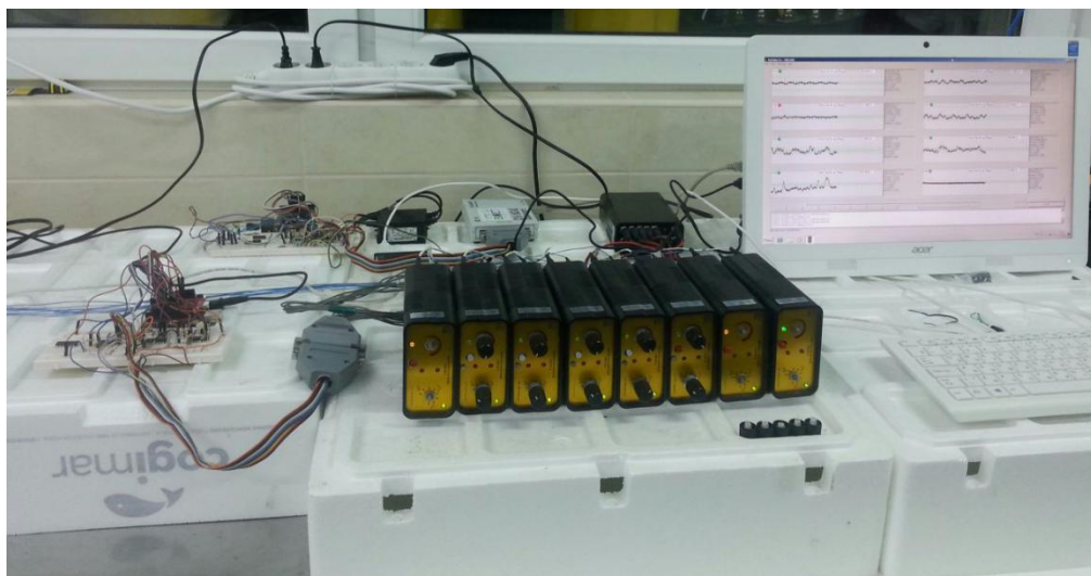
Slika 6.35. Unapređenje opreme u dijelu prenosa podataka – realizovana WiFi konekcija između mjerne opreme i centralnog računara
