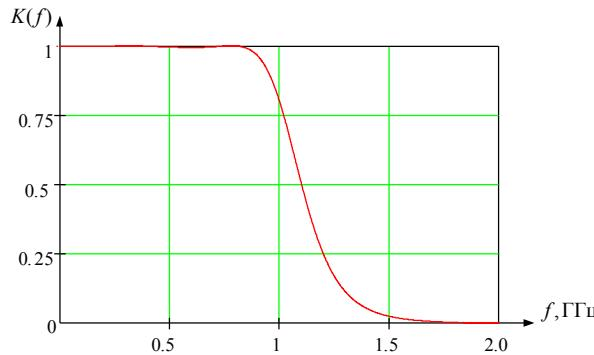
Рис. 2. Частотная характеристика фильтра СВЧ пятого порядка
