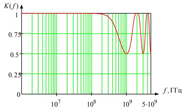
Рис. 1. Частотная характеристика фильтра Баттервортса второго порядка
