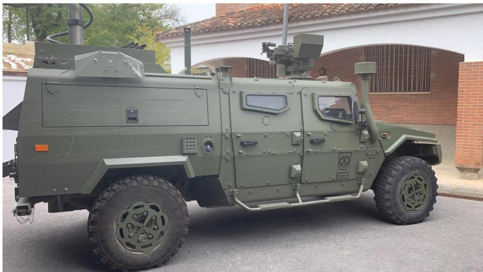
Ilustración 5. Vista lateral del VERT. Pueden observarse las placas de blindaje cerámico en las puertas
