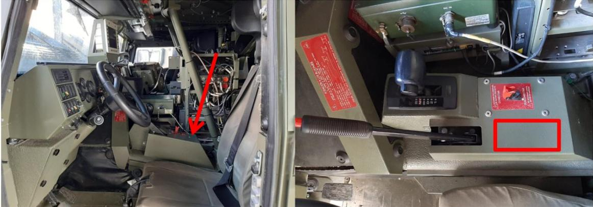
**Ilustración 7. Posición del mando acelerador de mano en el puesto del conductor**
