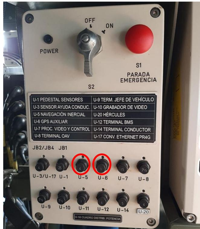
Ilustración 8. Cuadro distribuidor de potencia U-18. Pueden apreciarse los fusibles U-5 y U-6
