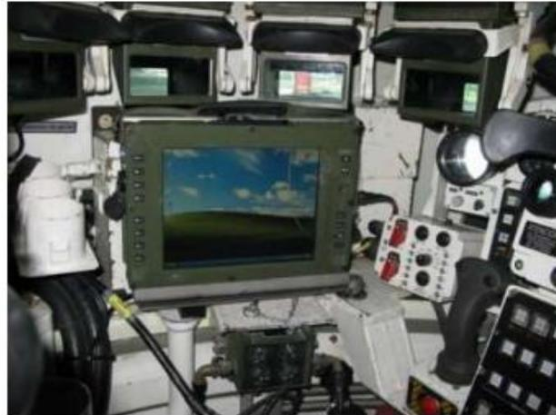
Ilustración 2. BMS instalado sobre CC LEOPARDO 2E. Fuente: asignatura de la AGM "Sistemas de Mando y Control de Caballería".
