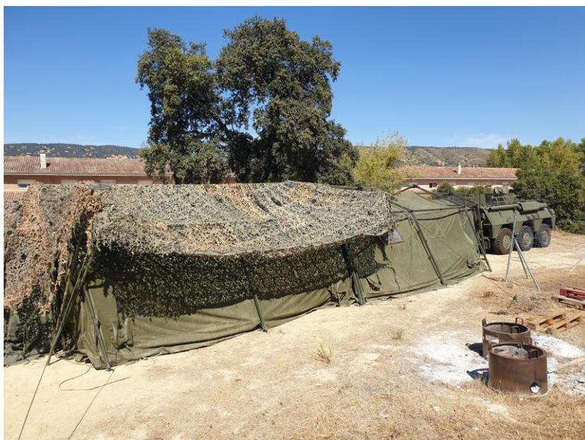
*Ilustración 19. Estación PCBON montada sobre dos vehículos del tipo BMR. Fuente: fotografía del ELAC 2.*
