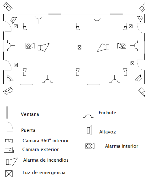
Ilustración 31 32 : Distribución electrónica del interior de la nave
