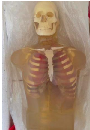
Ilustración 19 19 : Torso de gel balístico
