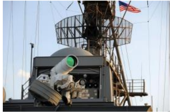
Imagen 8: Sistema láser de alta potencia instalado en un buque norteamericano. Fuente: desarrollodefensaytecnologiabelica.blogspot.com
