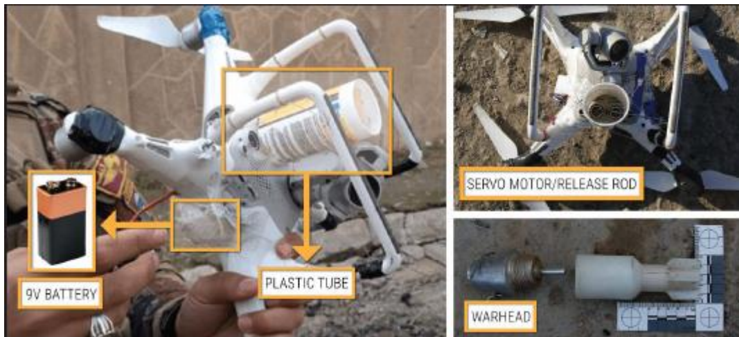
Imagen 10: Dron comercial modificado utilizado por el Estado Islámico. Fuente:[8]
