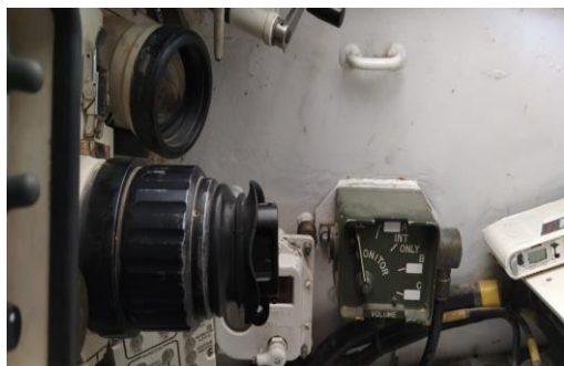
Figura 14. Representación de una "Go Pro" empotrada en el periscopio P204 del VEC. Fuente: Elaboración propia.
