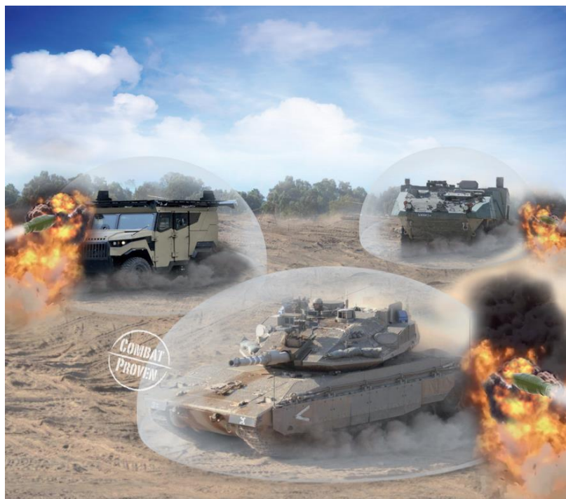
Ilustración 11. Funcionamiento del Trophy APS de misiles antibalísticos, donde se puede observar la "cúpula" de protección que ofrece de 360° alrededor del vehículo. Fuente: Imagen obtenida de la página web de la empresa Rafael.
