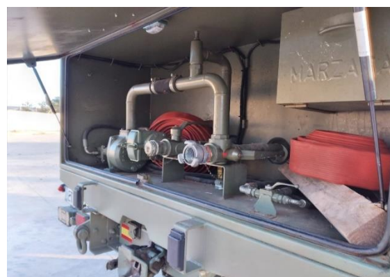
Ilustración 20 – Ajuste de la manguera para la desinfección.
