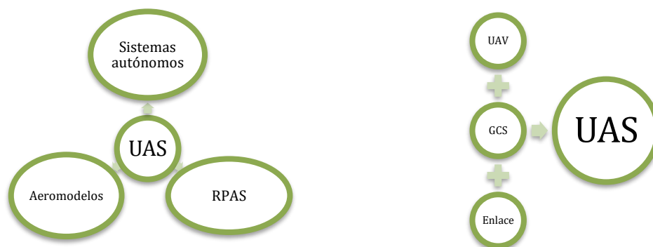
Gráfico 1: Conjunto de UAS y partes que lo forman.
