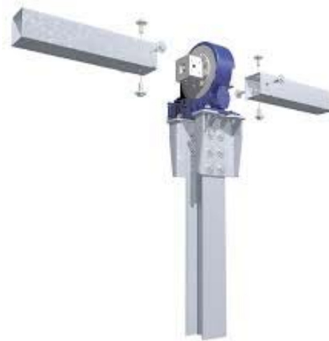
Detalle 4. Montaje Motorreductora
