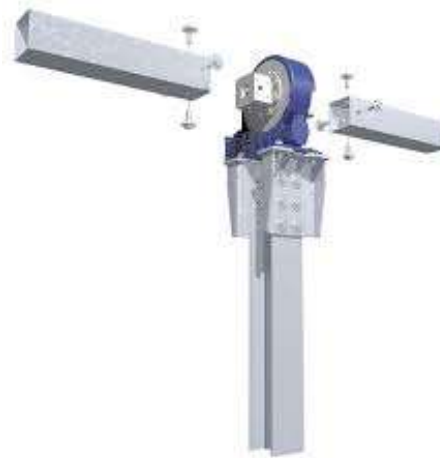
Detalle 4. Montaje Motorreductora
