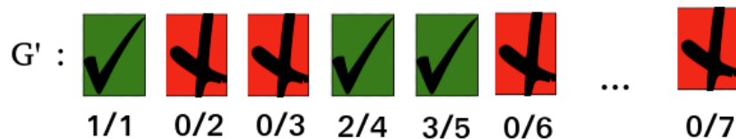
Figura 5.3: Cálculo de Average precision para una secuencia de aciertos y fallos. Se suman los resultados de todas las imágenes: 1+0+0+2/4+3/5+0 \dots
