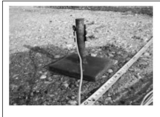
Gambar 4 Elektroda flat base yang digunakan oleh Athanasiou dkk dalam penelitian sebelumnya
