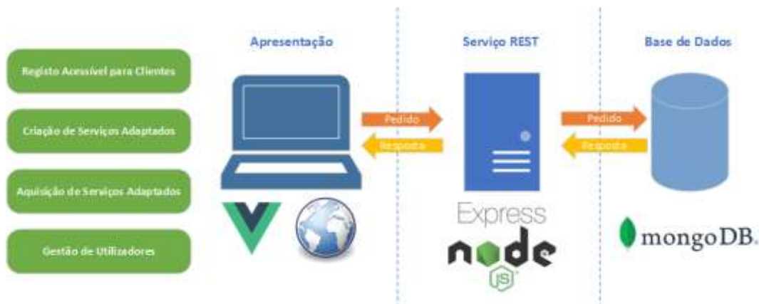
Figura 2 – Arquitetura geral da plataforma SEU
