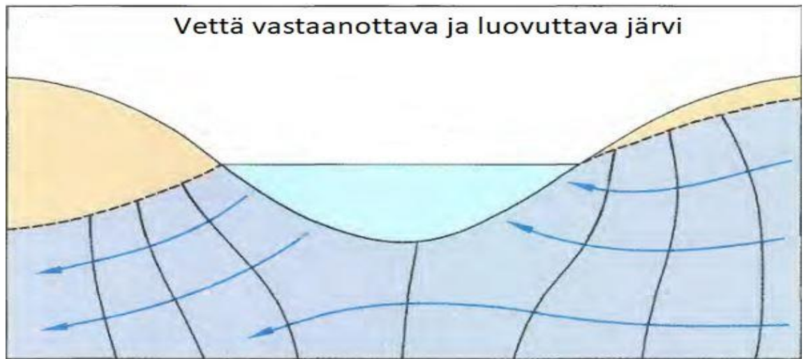
Kuva 7. Sekä vettä pohjaveteen luovuttava että pohjavedestä vettä vastaanottava järvi (mukaiillen Winter et al. 1998, s. 18).
