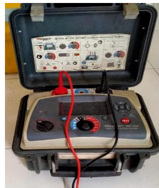
Gambar 5 Megger (Megaohm Meter) (Sumber : ULTG Pontianak)
