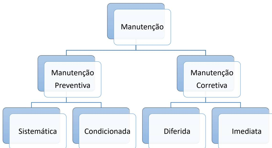
Figura 4 - Classificação dos diferentes tipos de manutenção segundo a norma NP EN 13306:2010 – Terminologia da Manutenção.
