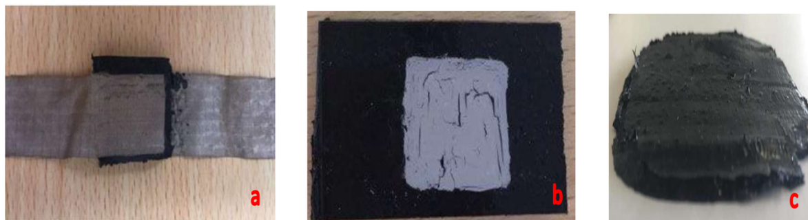
Fig. 12 Desenvolvimento e preparação de sensores de pressão: a) sensor de silicone condutor e tecido condutor, b) sensor de silicone condutor e tinta condutora estampada, c) exemplo de silicone produzida.
