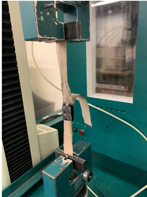
Fig. 64 Ensaio desprendimento 6388.003net (acervo do autor).
