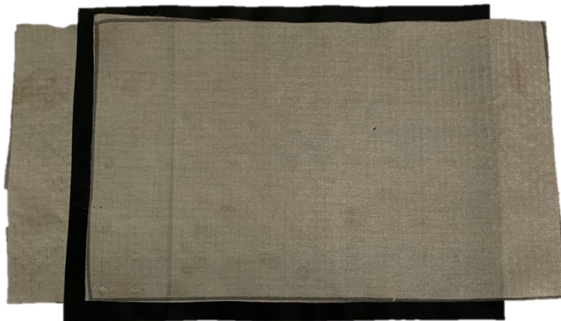
Fig. 20 Sensor de pressão têxtil piezoresistivo (acervo do autor).
