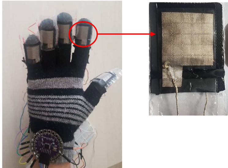
Fig. 14 Luva que monitoriza a pressão das falanges.
