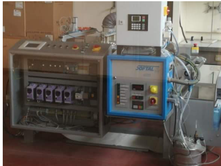
Fig. 43 Equipamento DBD - Tratamento plasmático (acervo do autor).
