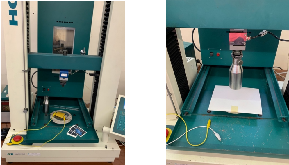
Fig. 33 Equipamento de teste - Dinamômetro Hounsfield H10KS com câmara climática HENV (acervo do autor).
