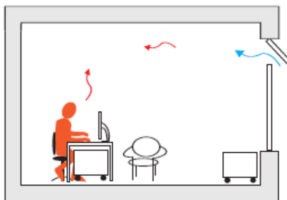
Figura 6 - Exemplo de ventilação unilateral (Kleiven, 2003)
