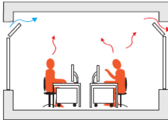
Figura 7 - Exemplo de ventilação cruzada (Kleiven, 2003)
