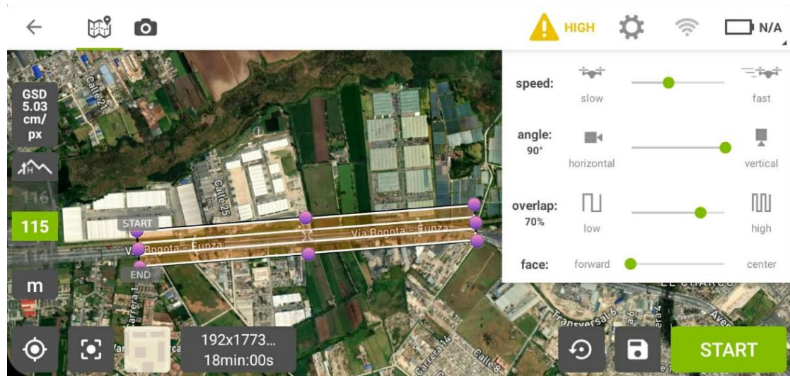
Imagen 2. Programación de vuelo en Pix4D para un tramo vial
