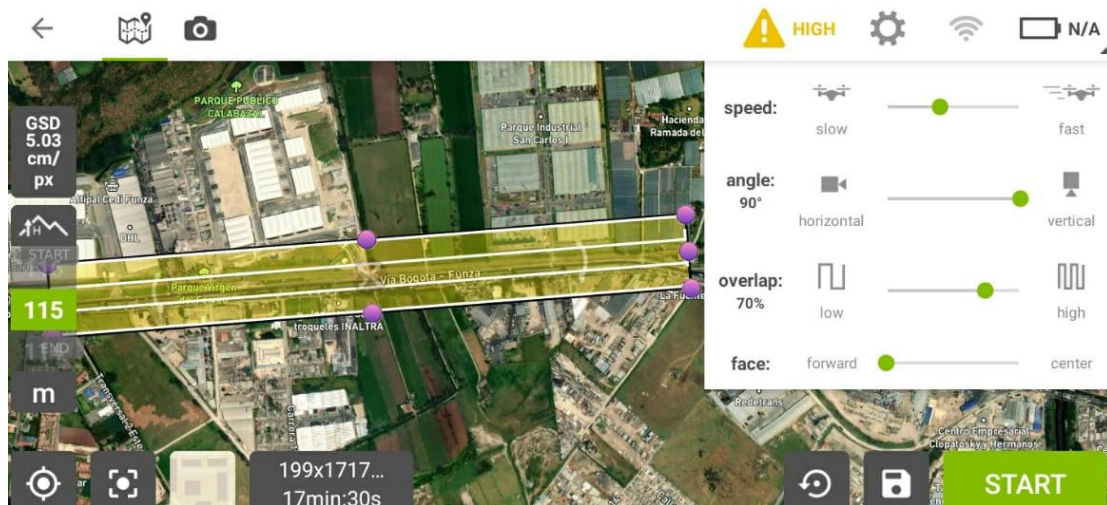
Imagen 1. Programación de vuelo en Pix4D para un tramo vial
