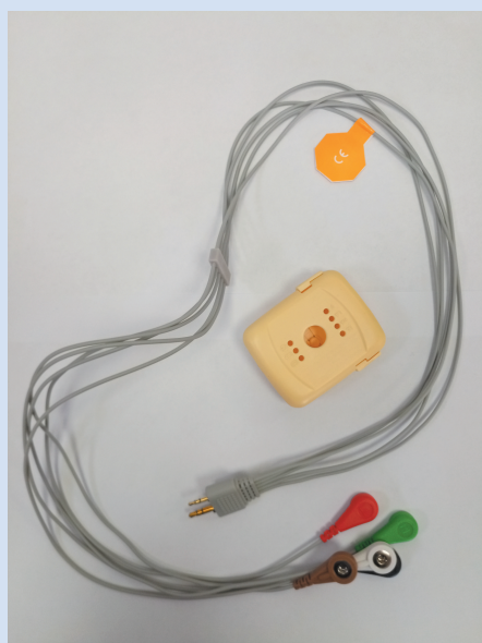
Рисунок 2. Корпус и электроды модели Alterholter02 Figure 2. Device case and electrodes of the Alterholter02
