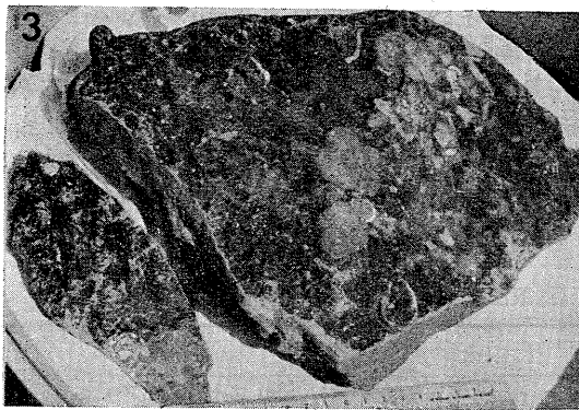
第 1 図 1. 駒橋第 2 海山で採取されたマンガン団塊中の黒雲母花崗岩礫 (GDP 8-12-9) (長径 6 cm) 2. 駒橋第 2 海山で採取されたマンガン団塊中の曹長石—トーナライト様角礫 (GDP 8-12-10) (長径 8 cm) 3. 第 2 紀南海山で採取された凝灰岩塊 (GDP-8-4) (長径 32 cm) 4. 3 の凝灰岩の反射電子像 (組成像)・A; Mg, Al, (Fe) の珪酸塩. B; Mg と Al の含水 硫酸塩. C; 沸石. D; 炭酸塩鉱物. (単位 100 \mu )
