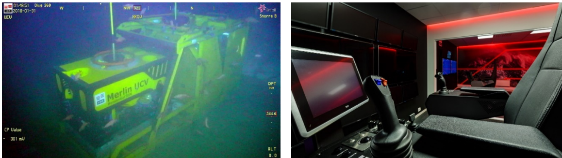
Figur 2: Fastboende ROV fra IKM med tilhørende kontrollrom på land. Foto: IKM.
