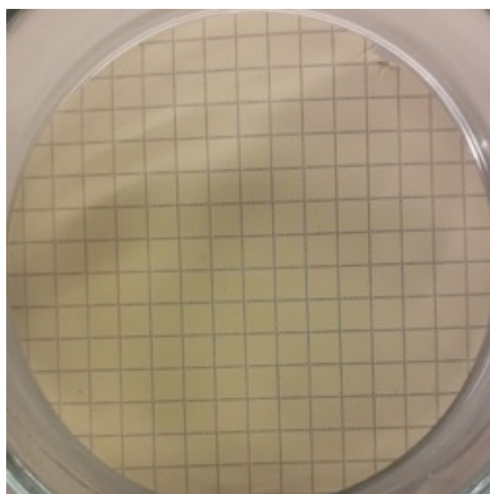
Figur 13. Mobilbilder av tørkede filter (Ø 47 mm; 0,45 µm porestørrelse fra trinn 11 FASE II, figur 9). LF: 1m; laksefôr tilsatt mikroplast (10 biter PE og 10 biter PET), C-LF: 5m: kontrollprøve med tilsatt mikroplast. LF: 3u og C-LF: 7u er tilsvarende prøver uten tilsatt mikroplast. Hver rute på filtrene er 3 x 3 mm.
