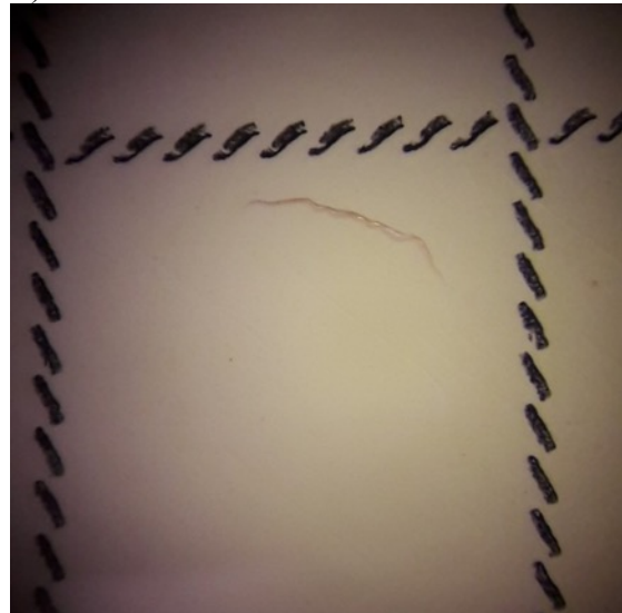
Figur 14. Mikroskopbilder av de tilsvarende prøvene som vist i figur 13. Hvert bilde viser omtrent en 3 x 3 mm rute og gir eksempel på mikroplast tilstede i prøvene. Mikroskopbildene ble brukt til å komme frem til antallene gitt i tabell 6.
