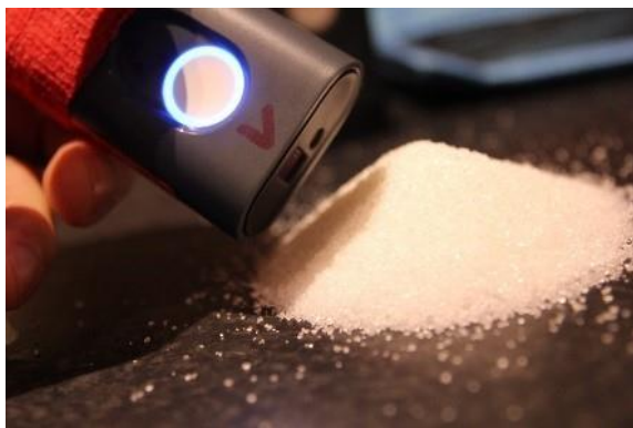
Figur 1 - Bilde av SCiO som skanner et hvitt stoff
